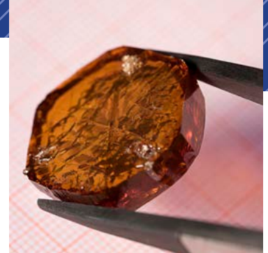
Aluminiumnitrid-Kristall als Halbleitergrundmaterial für leistungselektronische Bauelemente. © Anja Grabinger / Fraunhofer IISB
