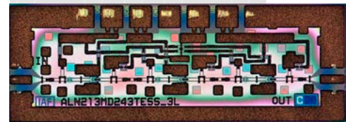
Verstärkerschaltung mit MOSHEMT-Transistoren bei 243 GHz. © Fraunhofer IAF
